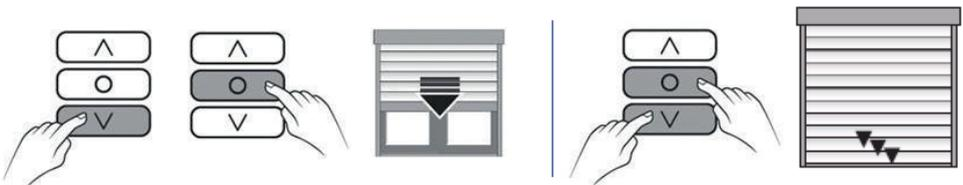
Appuyer brièvement sur la touche DESCENTE, pour mettre le volet en fin de course haute et ajuster le en pas à pas en faisant DESCENTE et STOP en même temps.
