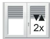
Appuyer plus de 3 secondes SIMULTANEMENT sur les touches Stop et Descente jusqu'à ce que le voyant s'allume. Le moteur s'actionne brièvement 2 fois,
