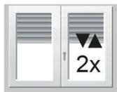
Appuyer simultanément sur MONTEE et DESCENTE pendant plus de 3 secondes.
