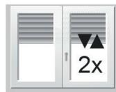
Appuyer simultanément sur STOP et DESCENTE pendant plus de 5 secondes.
