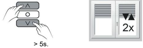
Appuyer simultanément sur MONTEE et DESCENTE pendant plus de 5 secondes.
