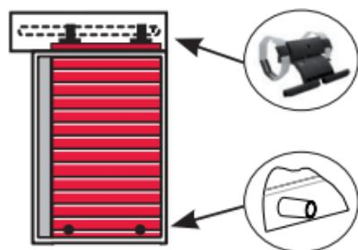
Avant d'installer le moteur, vérifiez que sur le volet est bien équipé de verrouillages de sécurité supérieurs et de butées inférieures.
